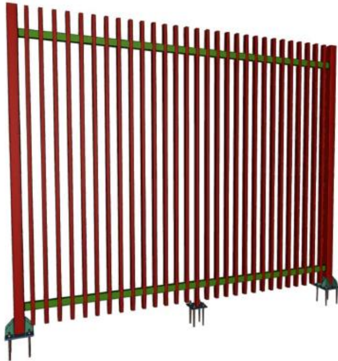
Imagen No. 1. Detalle isométrico sección de encerramiento perimetral propuesto
